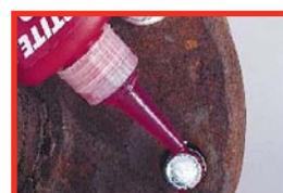
**Fijador LOCTITE 263™ - resistencia alta / Sin primer**
